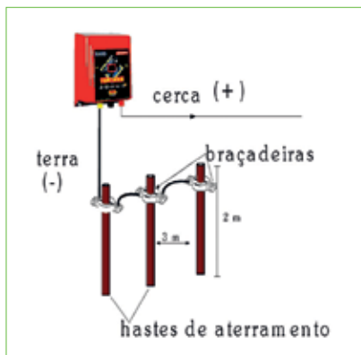
Imagem 3: Espaçamento entre e profundidade das barras de aterramento Fonte: Embrapa (2008).
